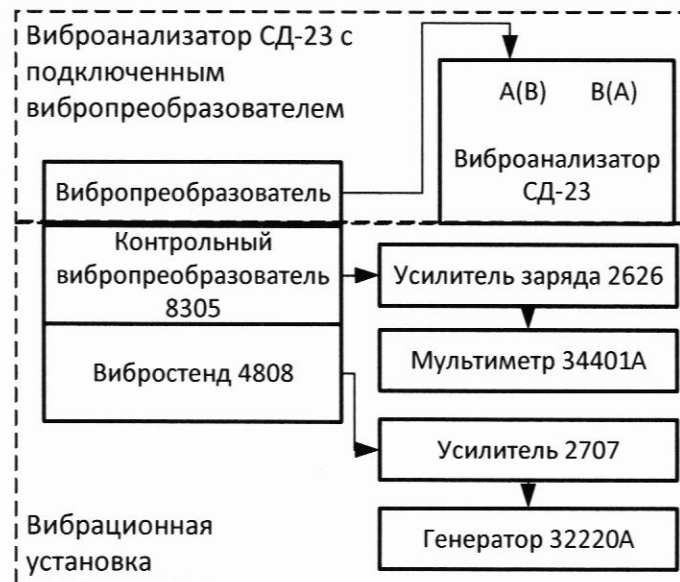
Рисунок А.6 – Схема стенда для проверки характеристик прибора с вибропреобразователями
