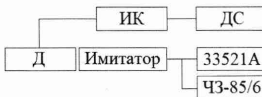
Р и с у н о к Б . 2 – Схема проверки ИК параметров относительной вибрации
