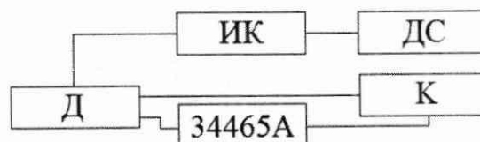
Р и с у н о к Б . 5 – Схема проверки ИК температуры
