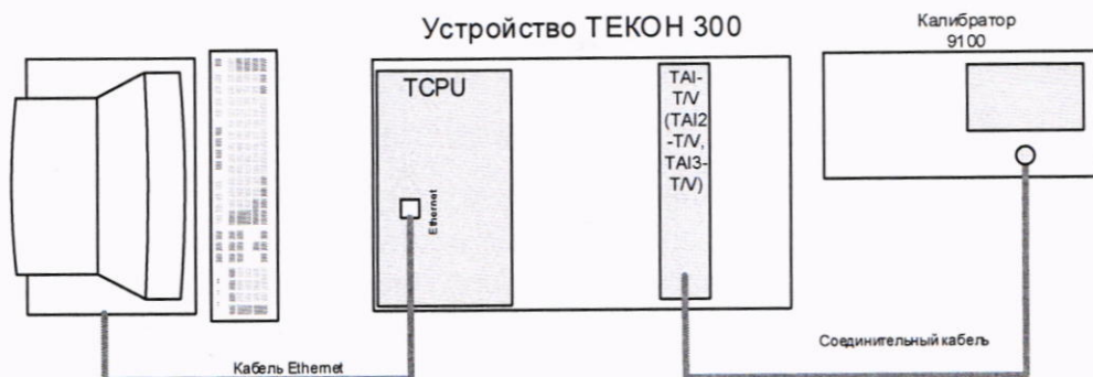
Рисунок 4 – Схема подключений при определении относительной основной погрешности измерений среднеквадратических значений силы переменного тока при I_{ном} = 1 А модуля ТАІ-Т/У (ТАІ2-Т/У, ТАІ3-Т/У)
