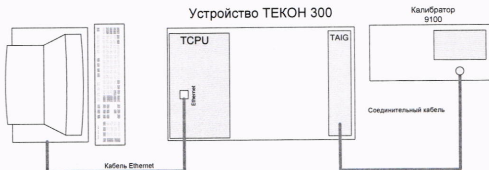
Рисунок 11 – Схема подключений при определении приведенной основной погрешности измерений силы постоянного тока
