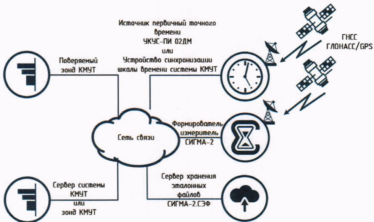
Рисунок 3 – Схема измерений для проведения опробования при периодической поверке
