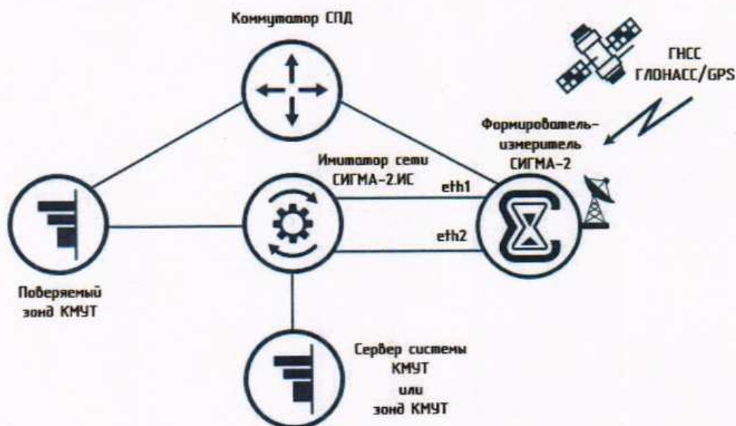
Рисунок 20 – Схема измерений для определения диапазона и погрешности измерений средней задержки передачи пакетов данных (PD)
