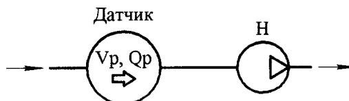
Рисунок 1 – Схема соединений при опробовании датчика. Н -турбокомпрессор (вентилятор или др.)
