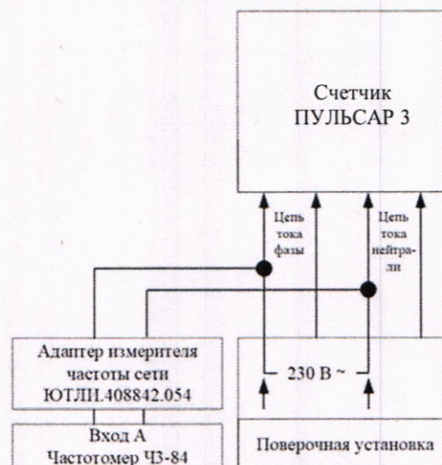
Рисунок 2 – Схема определения абсолютной погрешности частоты сети с применением частотомера
