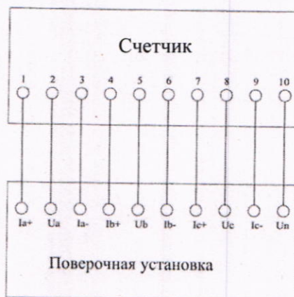
Рисунок 1 – Схема подключения счетчика к поверочной установке
