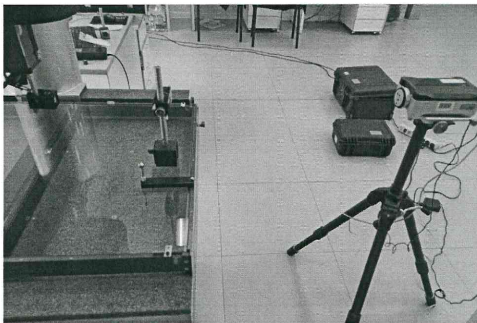
Рисунок 4 - Установка системы лазерной измерительной XL-80 в направлении оси Y для portalных микроскопов
