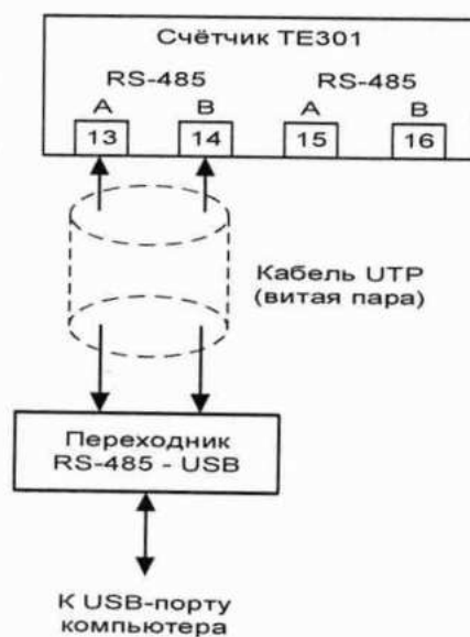
Рисунок Б.3 – Подключение цепей интерфейса RS-485
