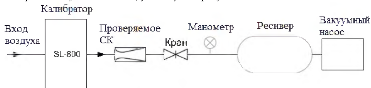
Рисунок 1. Схема подключений СК к ЭУ-5
