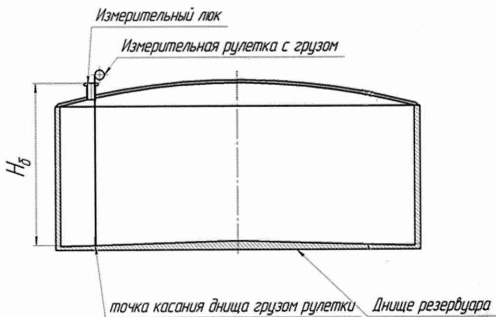
Рисунок А.1 – Схема измерения базовой высоты резервуара и эталонного расстояния уровнемера
