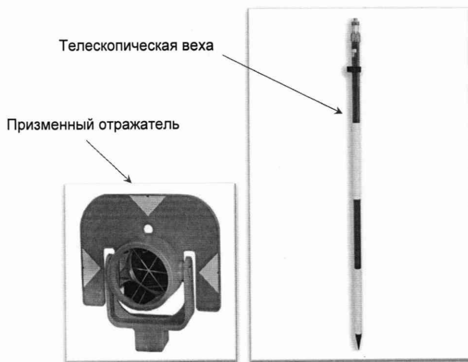
Рисунок А.1 – Вежа телескопическая с призмным отражателем
