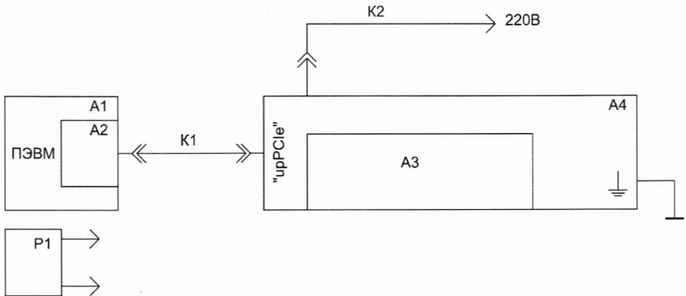
A1 – ПЭВМ с установленной платой Host Desktop adapter PCIe Keysight модель M9048B (GEN3 x8) A2
