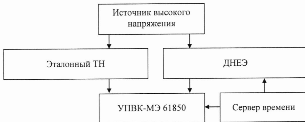
Рисунок 2. Схема для определения погрешности коэффициента масштабного преобразования и угла фазового сдвига напряжения переменного тока ДНЕЭ, оснащенного цифровыми выходами
