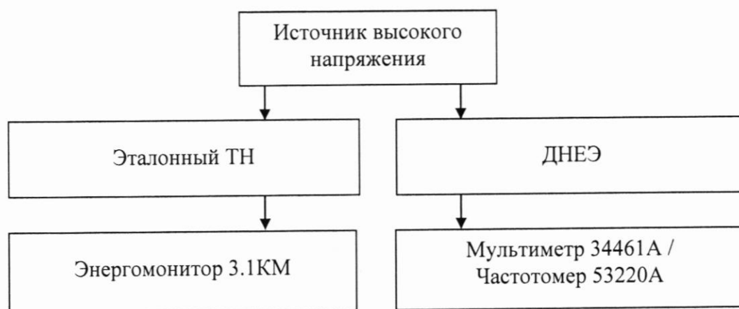
Рисунок 1. Схема для определения погрешности коэффициента масштабного преобразования напряжения переменного тока ДНЕЭ, оснащенного аналоговыми выходами
