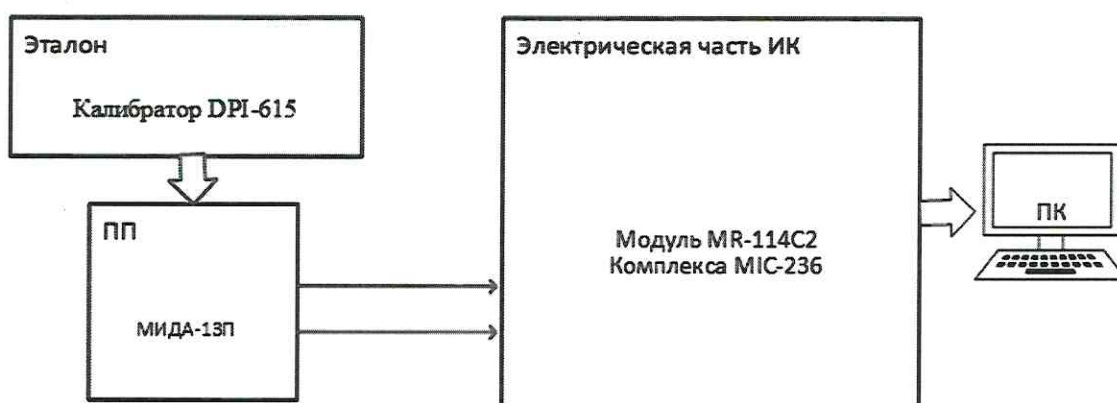
Рисунок 4 – Схема поверки ИК избыточных давлений комплектным способом
