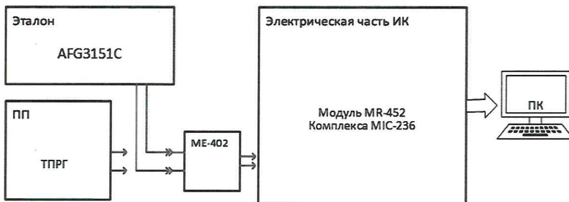
Рисунок 3 – Схема поверки ИК объемного расхода (прокачки) масла
