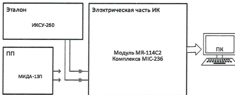
Рисунок 5 – Схема поверки ИК избыточных давлений поэлементным способом
