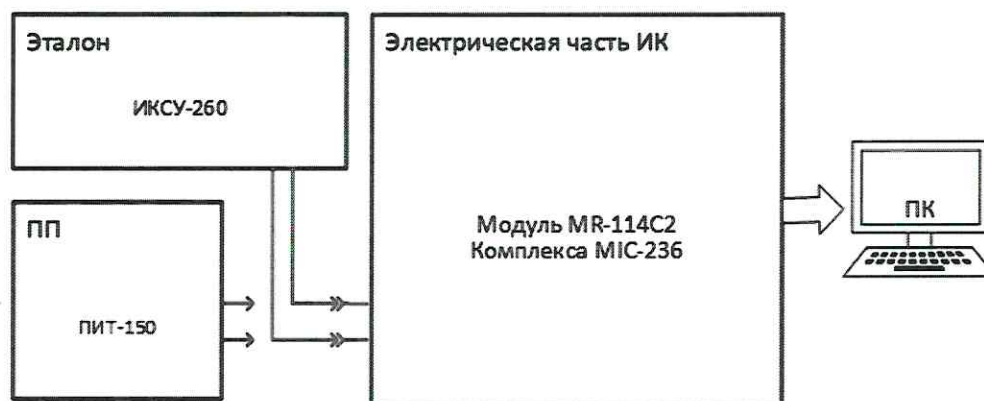
Рисунок 2– Схема поверки ИК силы постоянного тока
