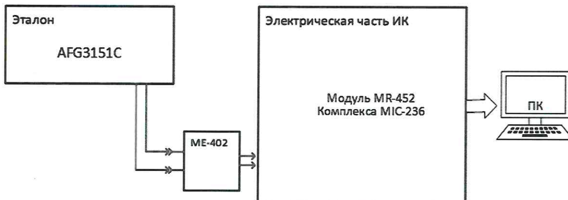
Рисунок 2 – Схема поверки ИК частоты вращения валов двигателя
