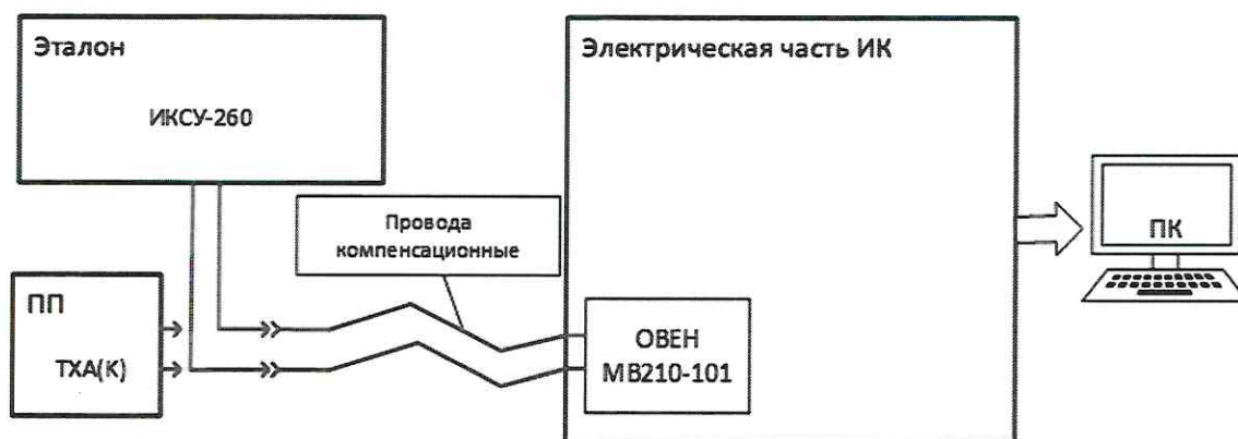
Рисунок 6 – Схема поверки ИК температуры в диапазоне преобразования ППП термоэлектрического типа
