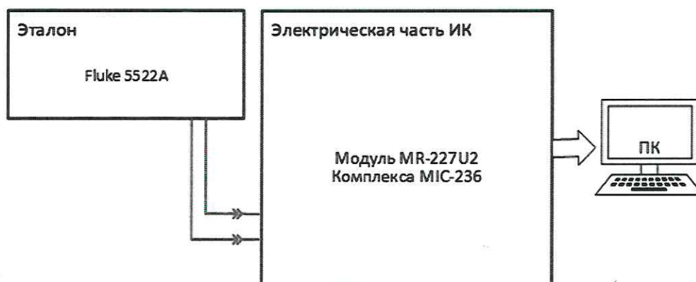
Рисунок 1 – Схема поверки ИК напряжения постоянного тока
