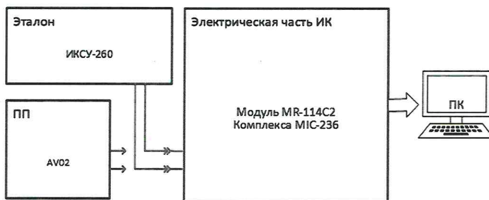
Рисунок 10 – Схема поверки ИК СКЗ виброскорости
