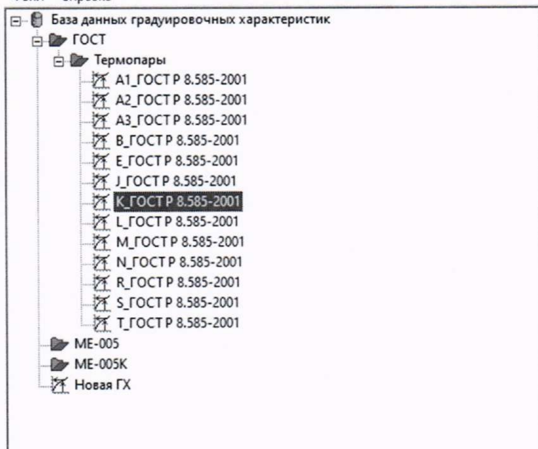
Рисунок Д6 – Окно выбора градуировочной характеристики, соответствующей типу подключаемой к каналу MIC-140 термопары
