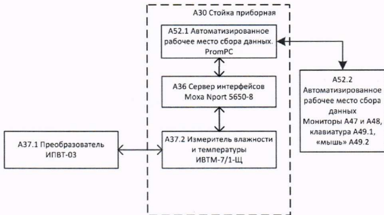
Рисунок 30 – Схема ИК температуры и влажности атмосферного воздуха
