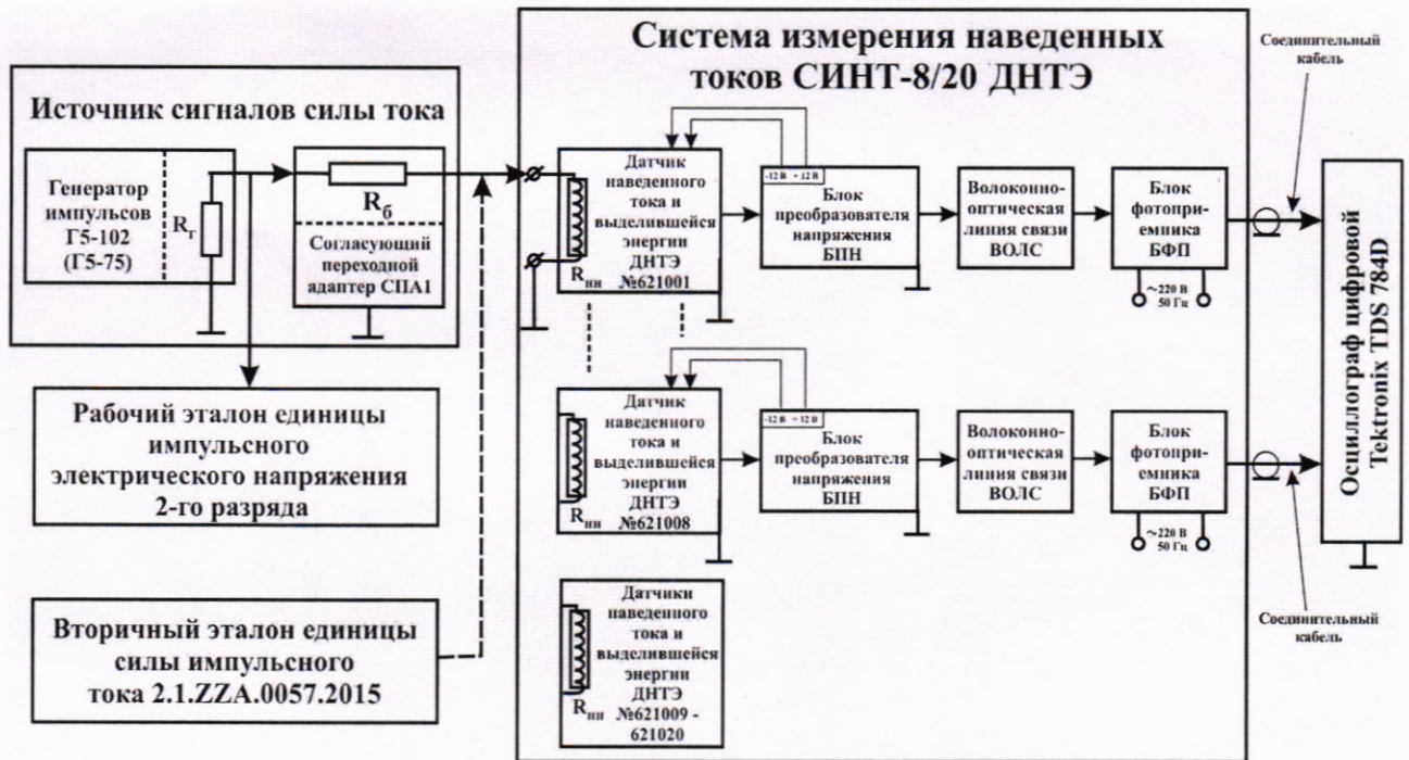
Рисунок 1 – Схема соединений при проведении измерений системы СИИТ-8/20ДНТЭ
