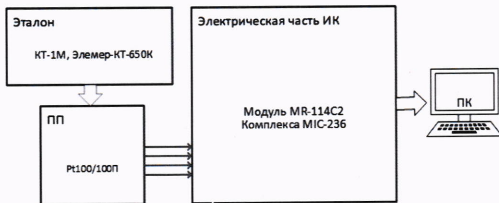
Рисунок 9 – Схема поверки ИК температур с ППП терморезистивного типа комплектным способом
