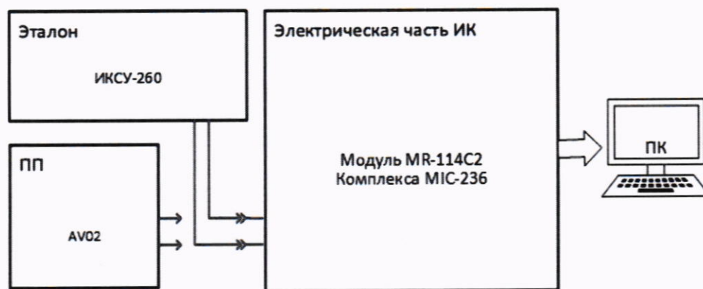
Рисунок 10 – Схема поверки ИК СКЗ виброскорости
