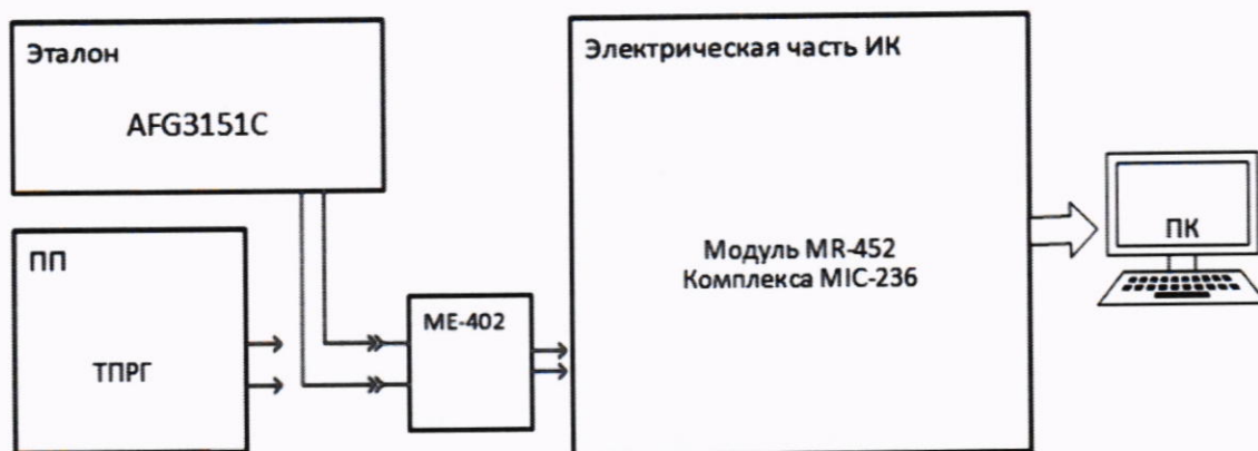
Рисунок 3 – Схема поверки ИК объемного расхода (прокачки) масла
