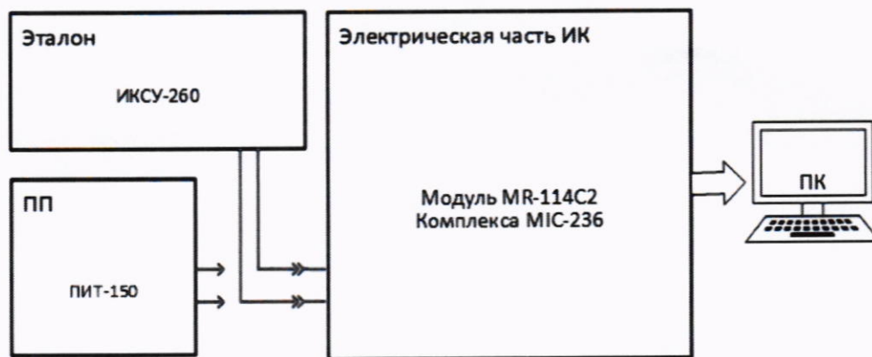
Рисунок 2– Схема поверки ИК силы постоянного тока
