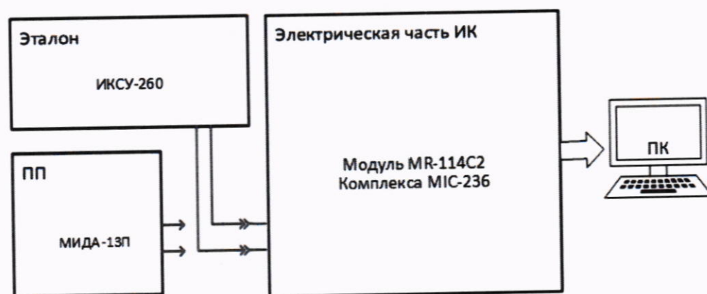
Рисунок 5 – Схема поверки ИК избыточных давлений поэлементным способом
