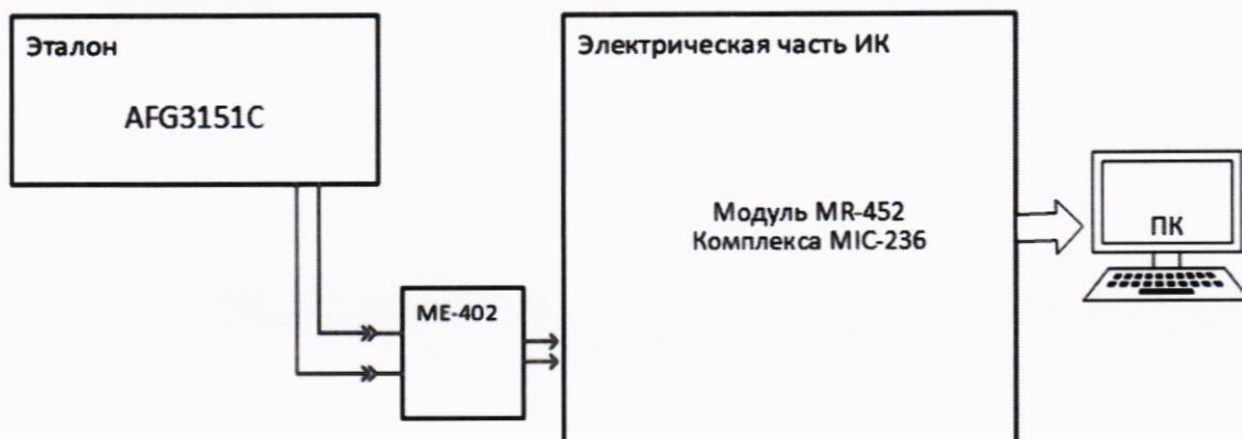
Рисунок 2 – Схема поверки ИК частоты вращения валов двигателя
