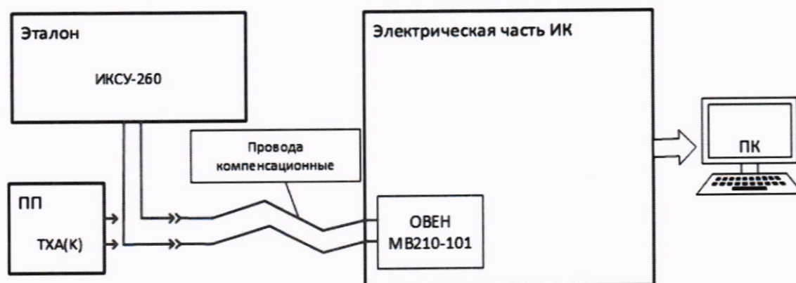
Рисунок 6 – Схема поверки ИК температуры в диапазоне преобразования ПП термоэлектрического типа
