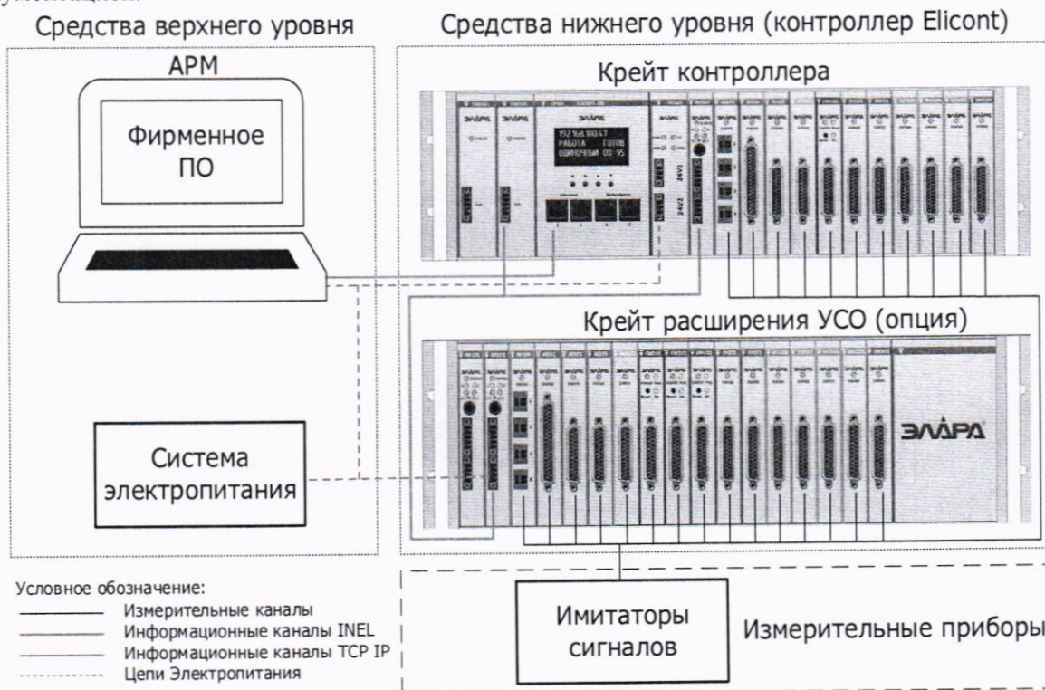
Рисунок 1 – Структурная схема стенда для поверки ИК
