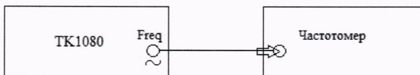
Рисунок 9 – Схема подключения калибратора в режиме воспроизведения частоты
