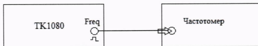
Рисунок 10 – Схема подключения калибратора в режиме воспроизведения частоты импульсного сигнала
