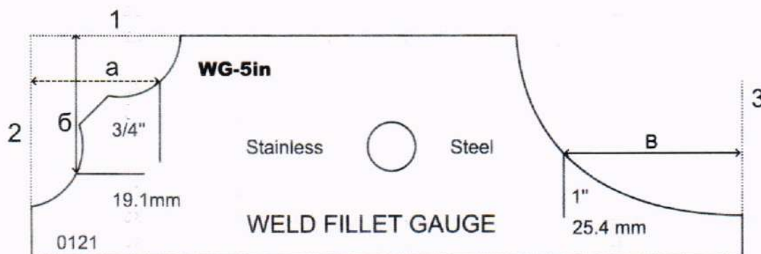
Рисунок 4 - Определение толщины и катета углового шва
