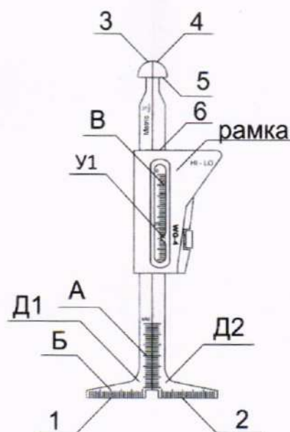
Рисунок 2 – Общий вид шаблонов сварщика универсальных WG, исполнение WG-4
