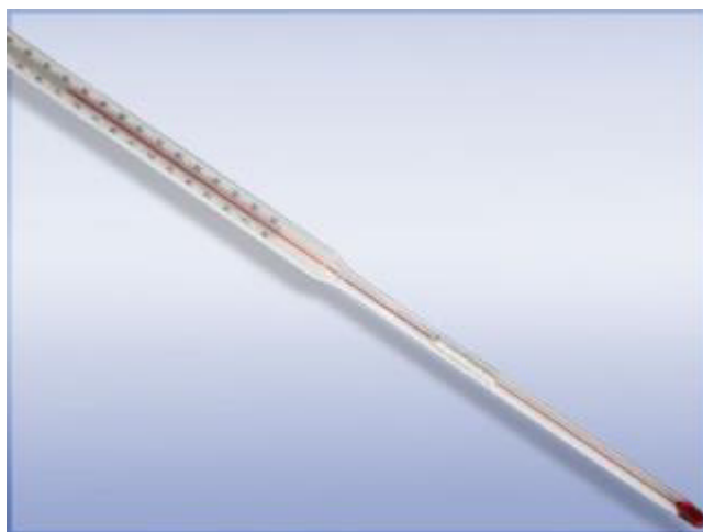
Рисунок 1 – Общий вид термометров стеклянных для испытаний нефтепродуктов ТН-8М
