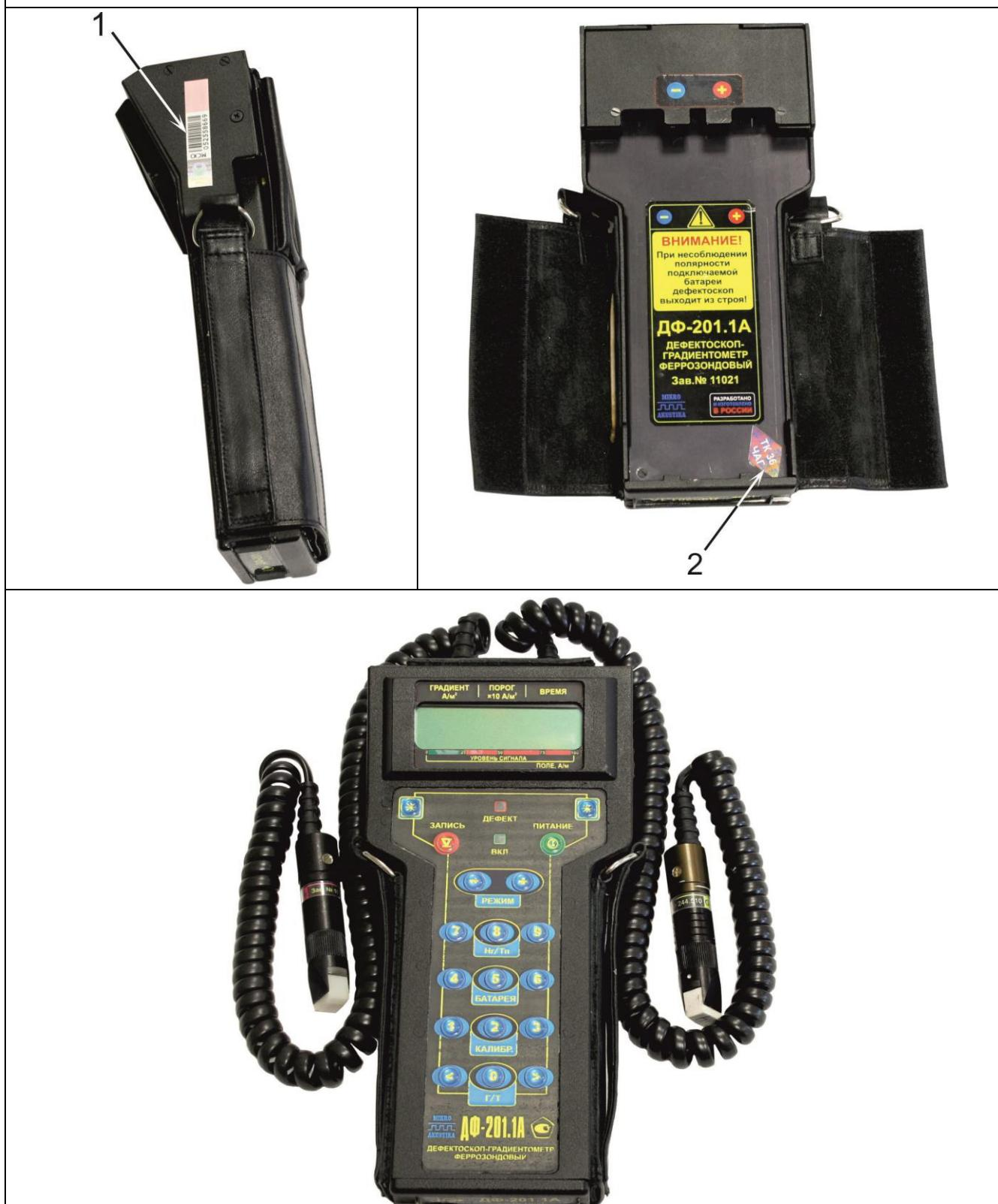
Примечание: стрелкой (1) обозначено место для размещения поверительного клейма в виде наклейки; стрелкой (2) обозначено место пломбировки для защиты от несанкционированного доступа.
