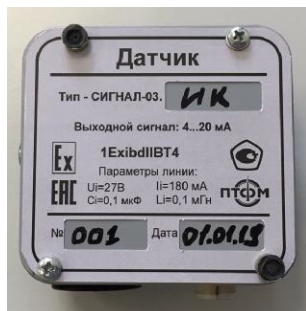
Датчик углеводородов с ИК сенсором (силуминовый корпус)
