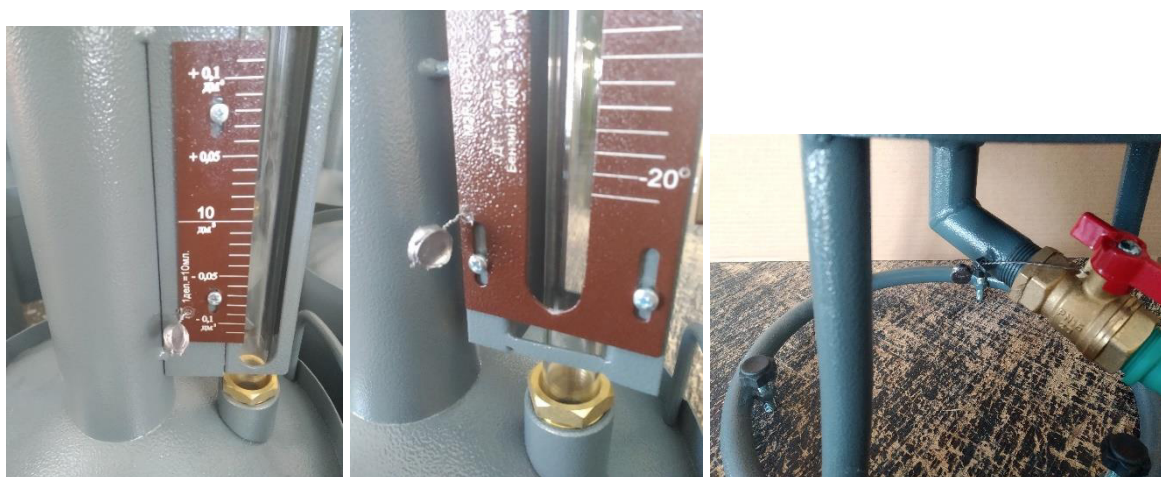
Рисунок 2 – Схема пломбировки от несанкционированного доступа, обозначение места нанесения знака поверки мерников
