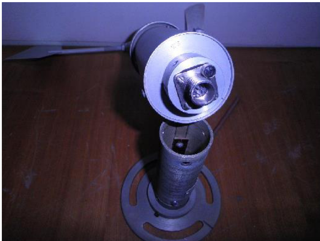
Рисунок 4 – место пломбирования ДСНВ от несанкционированного доступа
