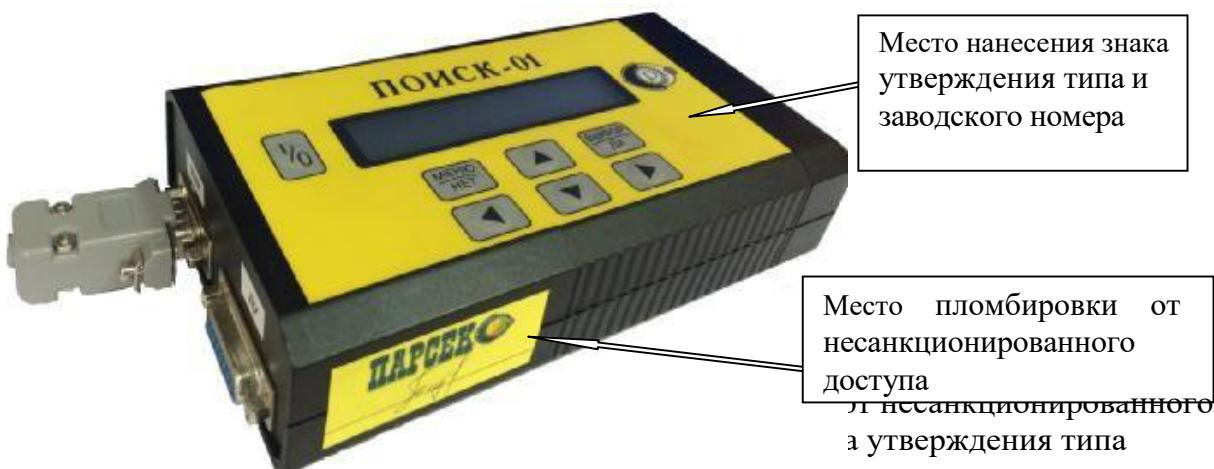
Заводской номер наносится на анализаторы на металлическую планку фирменную с обратной стороны анализатора. Формат нанесения заводского номера цифровой. Нанесение знака поверки на корпус анализаторов не предусмотрено.
