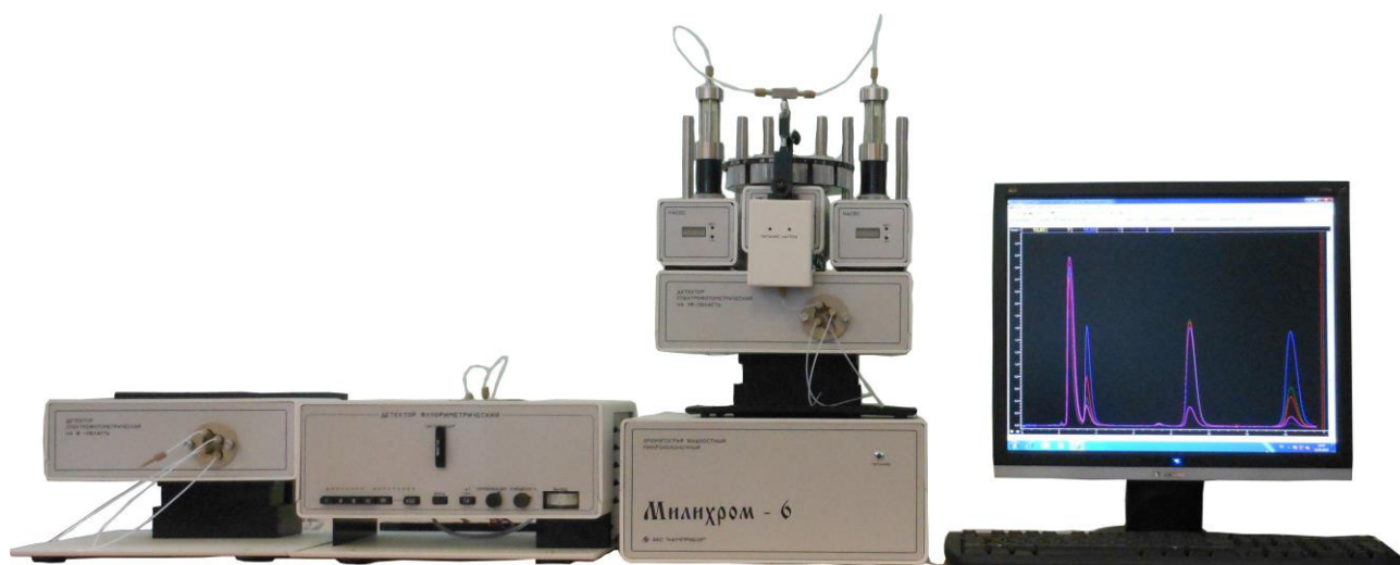
Рисунок 1 – Общий вид хроматографа жидкостного микроколоночного «Милихром-6»
