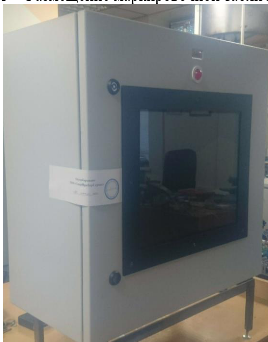
Рисунок 6 – Место пломбирования шкафа управления
