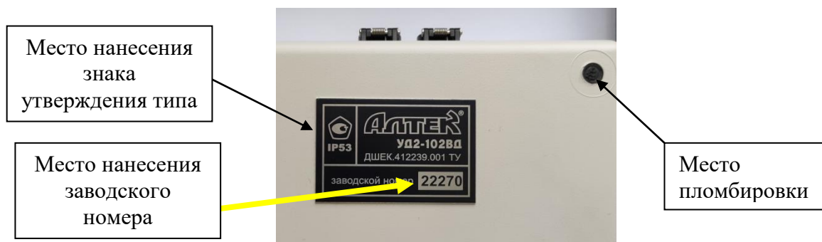
Рисунок 2 – Место нанесения знака утверждения типа, заводского номера и пломбировки дефектоскопа
