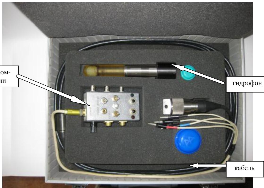
Рисунок 1 - Фотография общего вида гидрофона ГИ54
