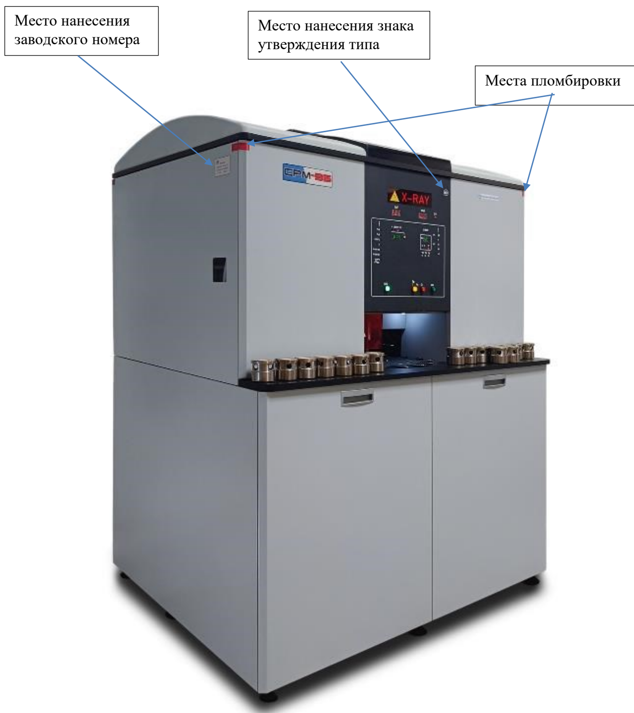
Рисунок 1 – Общий вид спектрометра рентгеновского многоканального СРМ-35 со стороны лицевых панелей
