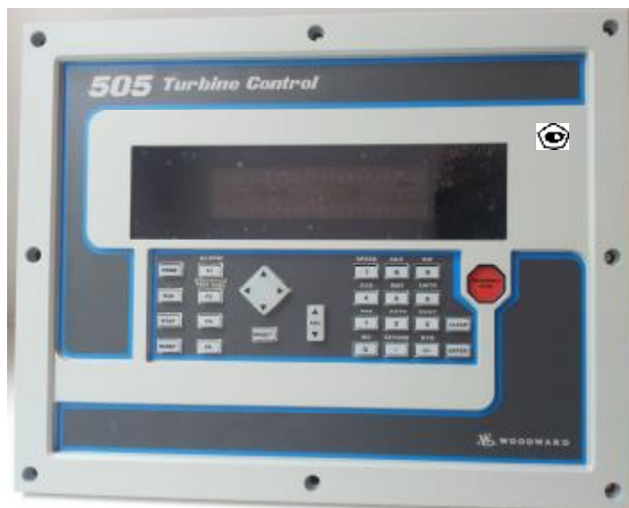
Рисунок 1 - Контроллер программируемый модели 505. Вид передней панели.
