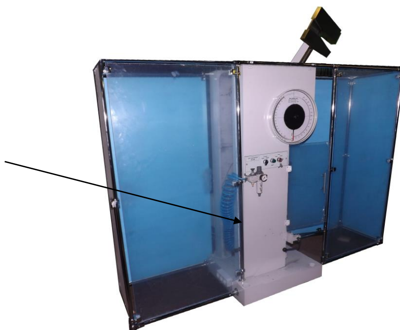
Рисунок 2.2 - Модель МК-300 с пневмо-подъемом молота
