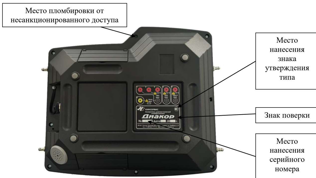
Рисунок 2 – Схема пломбировки от несанкционированного доступа, место нанесения знака утверждения типа и серийного номера
