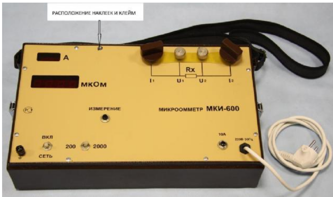
Рисунок 1 - Внешний вид микроомметра МКИ.
