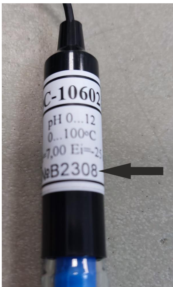
Рисунок 2 – Общий вид маркировочной таблички с указанием заводского номера
