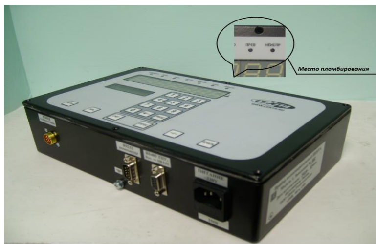
Рисунок 2 - Общий вид и схема пломбирования прибора ЦЕНТА
