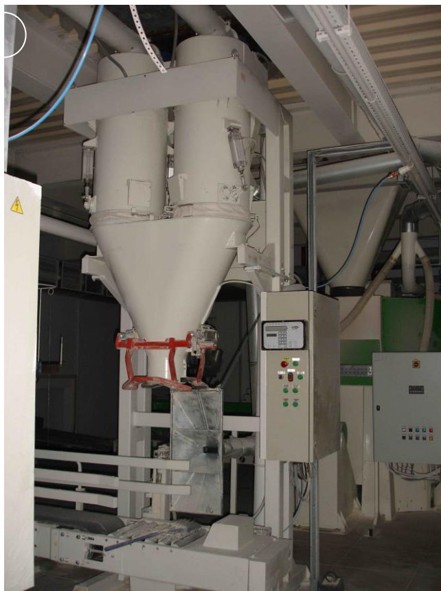
Рисунок 1 - Общий вид дозатора с двумя весовыми бункерами
