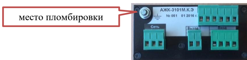
Рисунок 9 - Схема пломбирования АЖК 3101, АЖК-3101М, АЖК-3101ВП, АЖК-3102
