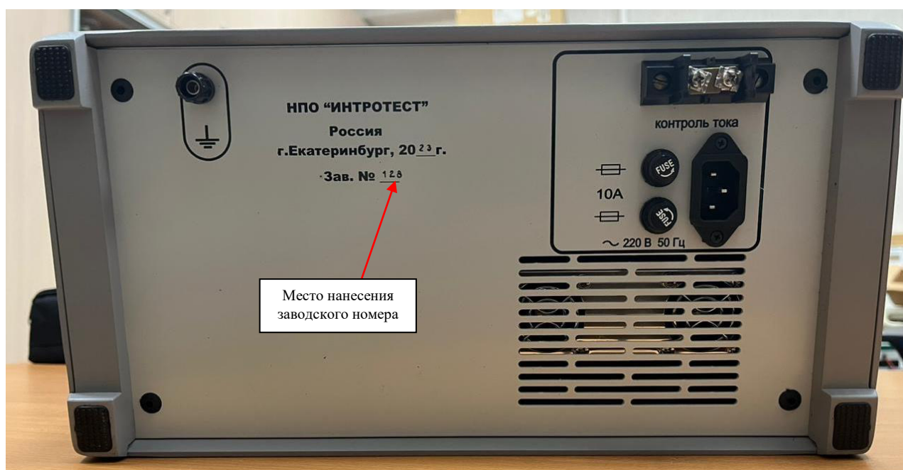
Рисунок 2 – Задняя панель электронного блока дефектоскопа
