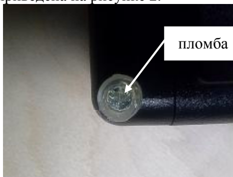
Рисунок 2 – Схема пломбировки газосигнализаторов
