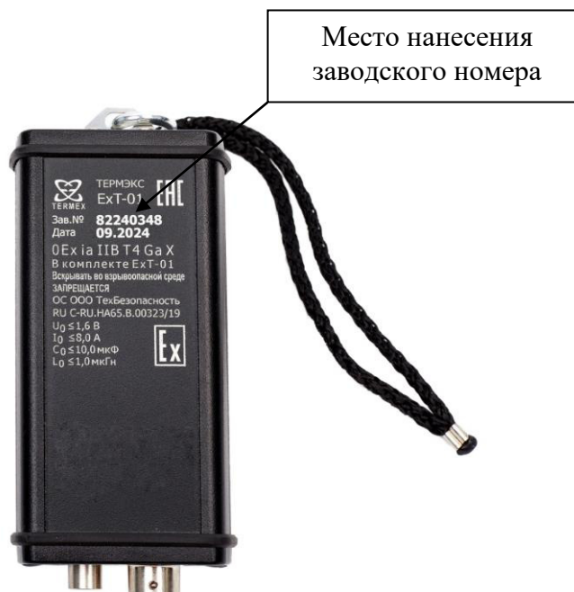
Рисунок 2 – Общий вид электронного блока термометра ExT-01 с указанием места нанесения заводского номера
