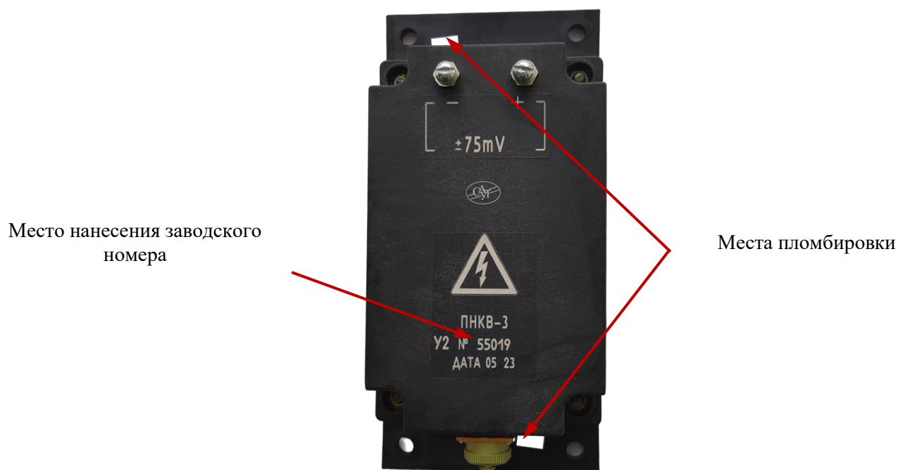
Рисунок 1 – Общий вид средства измерений с указанием мест пломбировки, места нанесения заводского номера
