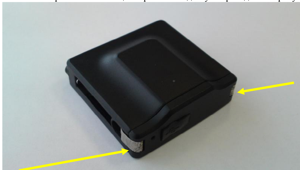
Рисунок 3 – Места размещения защитных пломб.
