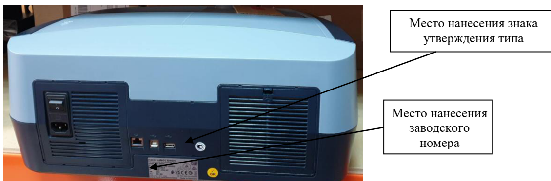
Рисунок 2 – Место нанесения заводского номера на спектрофотометр DR6000
