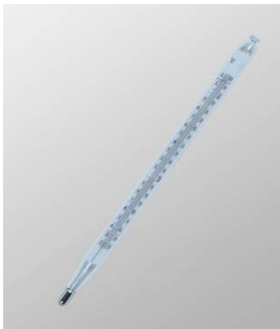
Рисунок 1 - Общий вид термометров стеклянных ртутных максимальных типа СП-83
