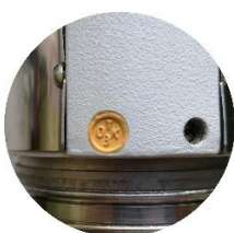
Рисунок 3 – Наружная пломба на стопорном винте, предотвращающем снятие корпуса электронного блока
