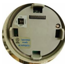
Рисунок 4 – Внутренняя гарантийная пломба под панелью управления с ЖКИ для исполнения МП1, МП2
