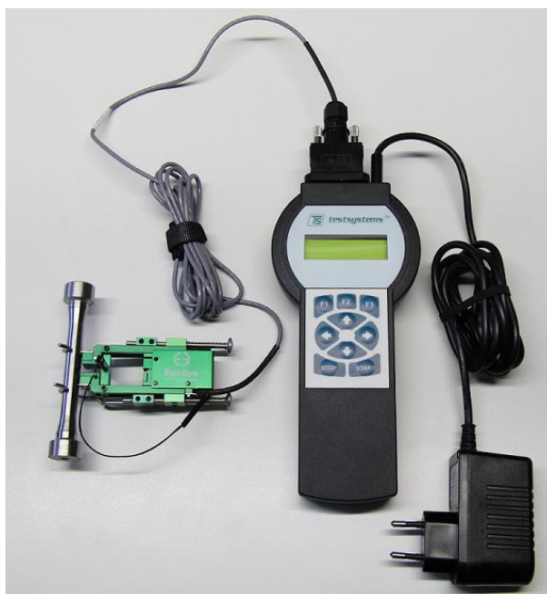
Рисунок 1. Внешний вид измерителей перемещений (деформаций) навесных ТС703
