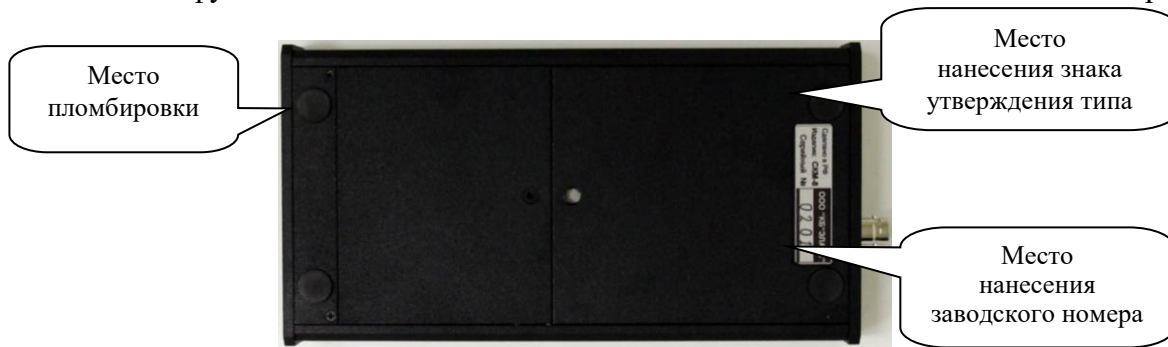
Рисунок 1 – Общий вид концентратора-анализатора низкочастотных сигналов multifunctional SKM-8 with marking of the place of application of the inspection mark
