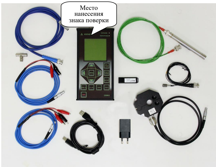
Рисунок 1 – Общий вид концентратора-анализатора низкочастотных сигналов multifunctional SKM-8 with marking of the place of application of the inspection mark
