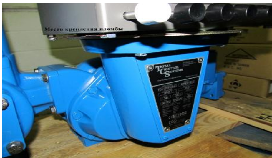
Рисунок 2 Место установки заводской пломбы на счетчики жидкости роторные TCS 700
